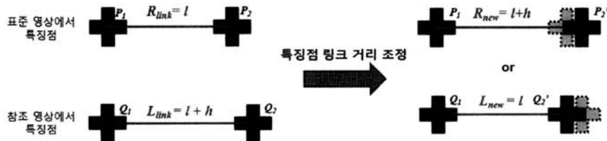
(그림 4) 특징링크의 길이가 수평 허용 범위 내에 있을 때, 특징링크 거리 조정
