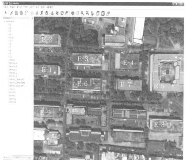
(그림 15) 사용자 인터페이스 (a) 도구바 - 모델 편집을 위한 각종 도구들을 제공. (b) 부가 정보 출력창 - 생성한 모델에 대한 모델에 대한 정보 및 텍스처 정보 등을 제공. (c) 3차원 모델 편집창 - 3차원 모델에 대한 편집 수행
