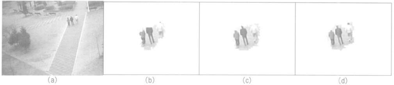
(그림 7) (a) 787번째 프레임의 원영상, (b) 4방향 LBP, (c) 6방향 LBP 및 (d) 8방향 LBP를 이용한 물체영역 추출 결과
