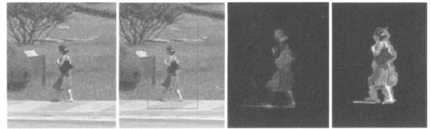
(그림 2) 이동물체의 추출. 좌로부터 입력영상의 일부, 물체 추적창 및 특징점, 메디안 필터링영상, 추출된 물체영역
