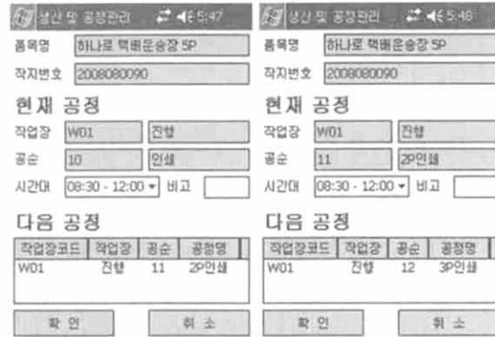
(그림 6) 이동식 RFID 리더를 사용한 공정 관리
