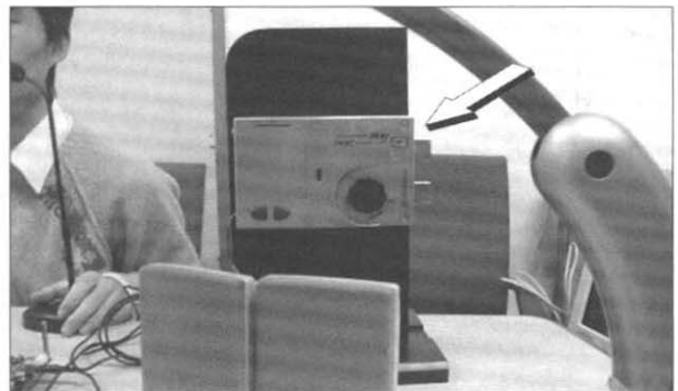
(b) 전자 열쇠 잠금 상태 (그림 8) 브라우저를 이용한 전자 열쇠 제어 실험
