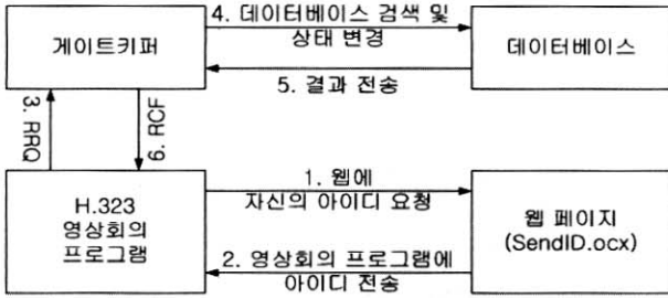
(그림 20) H.323 단말기의 게이트키퍼 등록 과정
