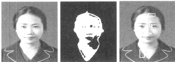
(a) 입력 영상 (b) 이진화 영상 (c) 영역 추출 (그림 15) 조명의 미 설정(측광)으로 인한 결과 획득 실패 영상
