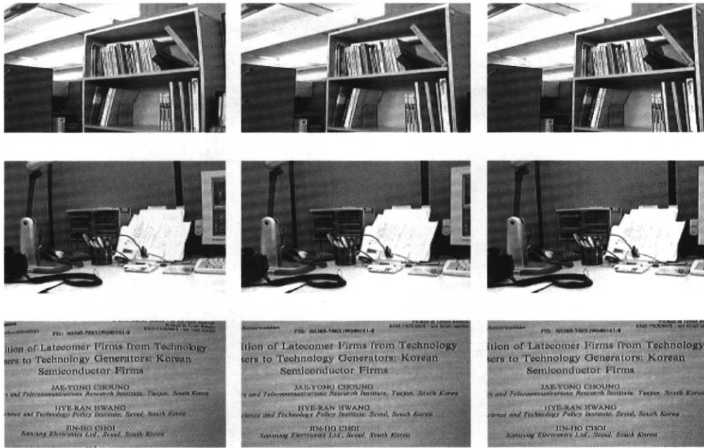
(그림 4) 삼성 MPC-C10 카메라로 촬영한 렌즈 왜곡 보정 전(왼쪽) 영상과 왜곡 보정 후(가운데)의 영상, 식 (12)를 이용한 렌즈 왜곡 변수값을 적용한 결과 영상(오른쪽)
