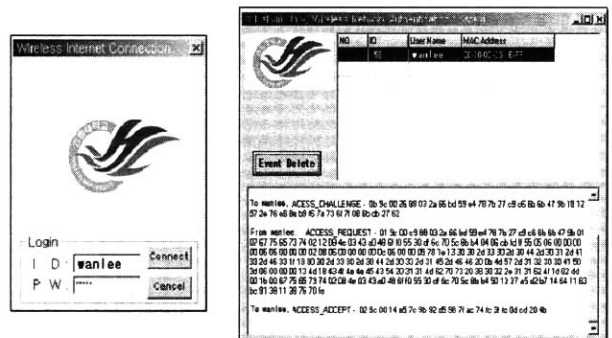
(a) 무선 단말기용 접속 프로그램 (b) 서버용 인증 연동 프로그램 (그림 10) 무선 단말기용 접속 프로그램과 인증 서버용 인증 연동 프로그램
